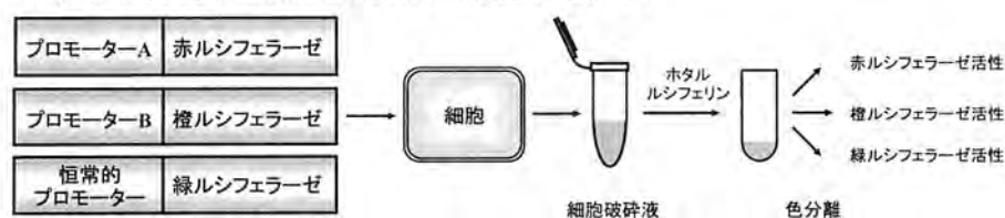
図2 デュアルおよびマルチカラールシフェラーゼアッセイによるトランジェントアッセイのスキーム
