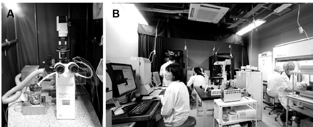
図4：カスタマイズの生物発光システムとラボ培養・測定室風景 A：生物発光測定装置3号機、顕微鏡ステージ上にはアクリルのカスタマイズミニインキュベータ、左側の温風装置から一定温度の温風と温めた蒸気を送る。酸素透過フィルムを使うようになってからは加湿器が不要となり、段々安価で作れるようになってきた。B：2009年の培養・測定室風景。後方には発光・蛍光・電気活動などの同時測定のための遮光テントが並ぶ。
