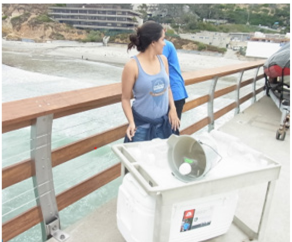
写真6 棧橋の端にある観測小屋から滑車をつかってタンクに海水を採取します。ラボに持ち帰りコンタミに注意しながら海水を濾します。
