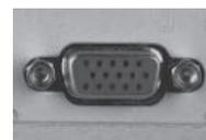
接続は、MiniD\_sub15ピン3列コネクタ（通常のモニター端子）となります。PC本体の外部モニター出力端子の形状を必ずご確認ください、必要な場合は専用の接続端子をご持参ください。
