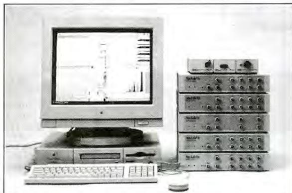
Sシリーズは10KHz-8ch、20KHz-4ch、40KHz-2chの連続サンプリングが可能です。
